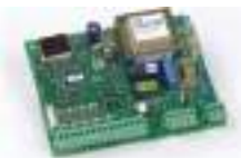
Steuerplatine 578 D (externe Installation) Technische Daten auf Seite 183
