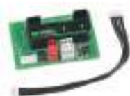
Schnittstelle für folgende Funktionen: Anschluss FAAC Funk / BUS 2easy / Master-Slave Betrieb und Schleusenfunktion
