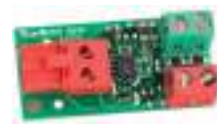
Schnittstelle BUS XIB (bei Verwendung der Steuerung E024S mit Fotozelle ohne BUS)
